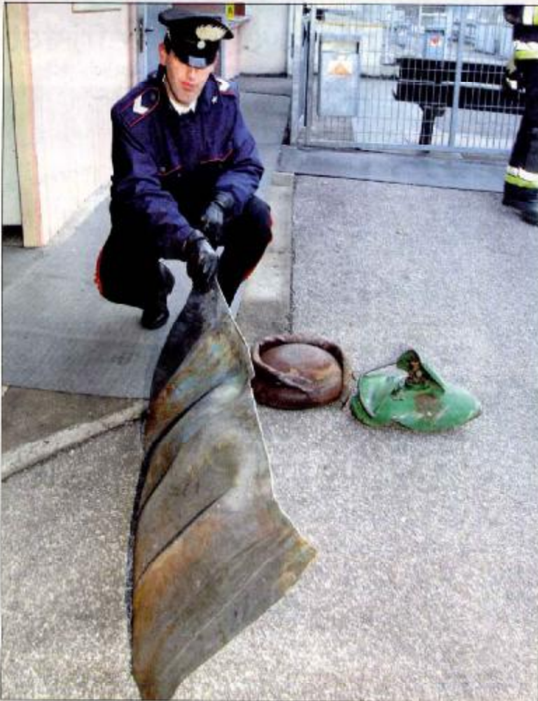
Ein Carabinieri zeigt alles, was von der zerknüllten Ammoniak-Flasche übrig geblieben ist: neben dem Kopf- und dem Bodenteil nur ein rechteckiger Metallstreifen, der zuvor der Mantel der Gasflasche war. Alle Fotos: J.P. / K. Gasser
